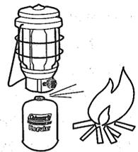
3. 使用中、玉ねぎの腐ったようなにおいがしたら、ガス漏れを起こしています。すぐに換気を十分にしてください。LPガスは比重が重く下部にたまりやすくなります。ガス漏れに気付いたときは、絶対に火をつけたり電気製品のスイッチを入れたり、火気の使用をしないでください。引火による爆発の恐れがあります。
