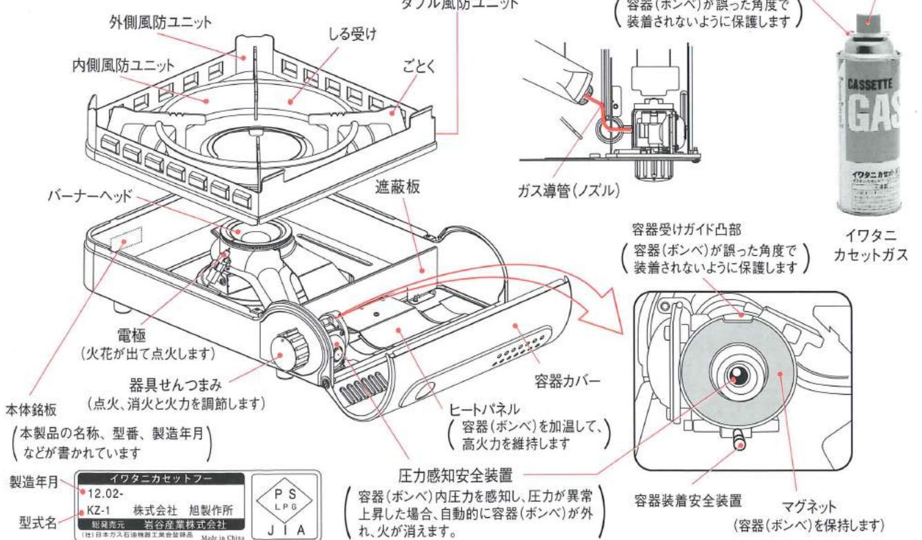
■清掃のため、内側風防ユニットと外側風防ユニットは分離できるようになっています。ダブル風防ユニットを裏返し、4ヶ所のごとくの裏外側の位置にあるごとくクリップを指で強くつまんで引くと、クリップがはずれます。4ヶ所のごとくクリップを全てはずすと内側風防ユニットと外側風防ユニットは分離できます。
